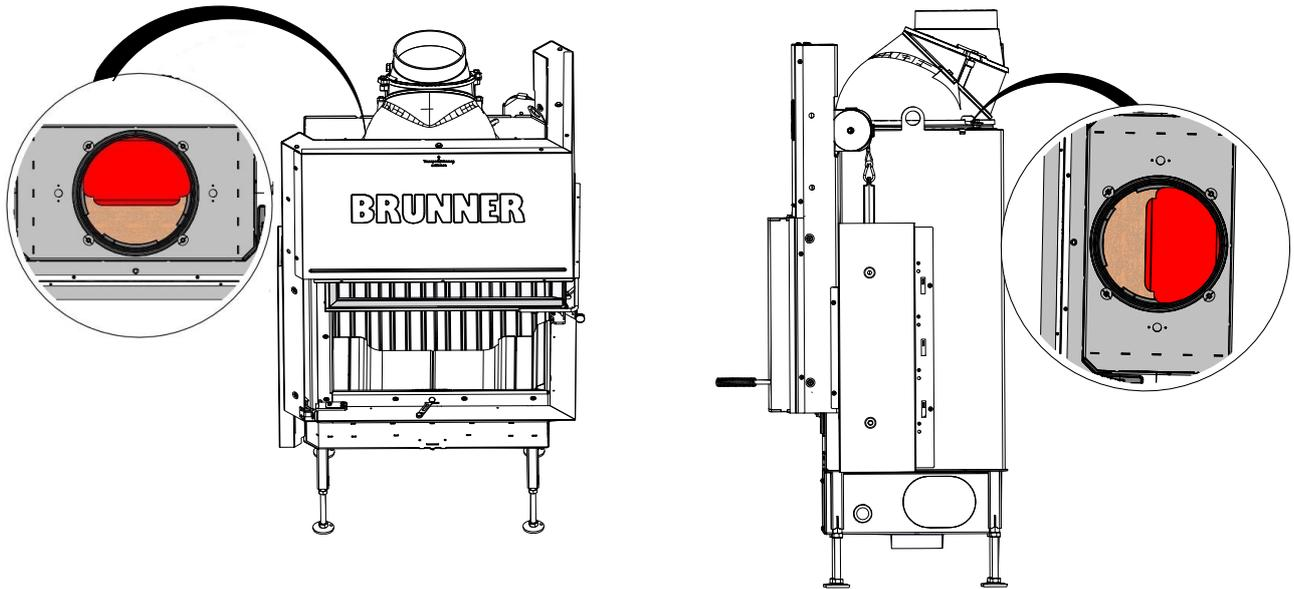
**2) Beispiel B: mit drehbarer Gusskuppel - nach hinten - waagrecht**
