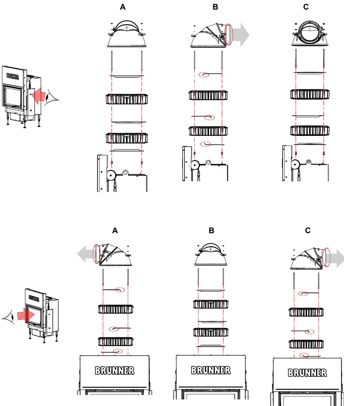
**5) Beispiel F: mit drehbarer Gusskuppel mit Wärmetauscherringe Guss - nach links senkrecht bzw. waagrecht**
